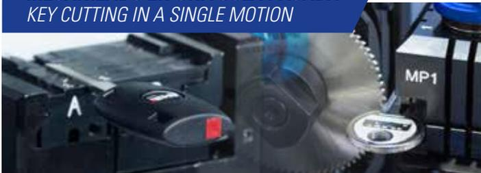
La potencia del motor de la máquina y la precisión del corte hacen posible que sólo se necesite una pasada para mecanizar la llave.
