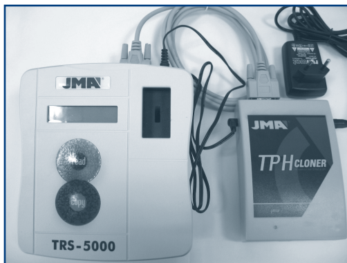
Fig. 3. Collegamento finale e dispositivi pronti per procedere alla clonazione.
