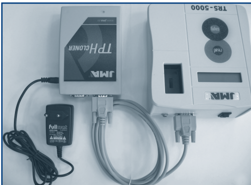
Fig. 2. Passi 1 e 2 per la connessione TPH Cloner e TRS-5000.
