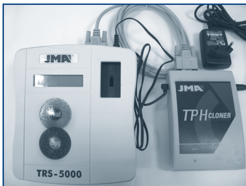
Rys. 3 Przedstawienie połączenia końcowego; zestaw urządzeń jest gotowy do klonowania.
