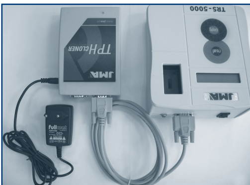
Fig.2. Muestra de los Pasos 1 y 2 en la Conexión TPH Cloner TRS5000.
