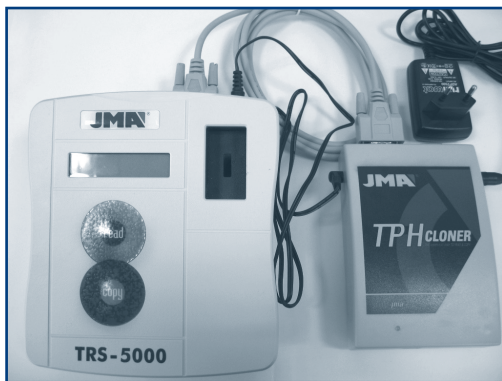
Fig.3. Muestra conexionado final y listo para proceder con la clonación.
