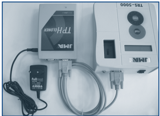
Abb. 3. Zeigt die angeschlossene Einheit, die nun bereit zum Klonen ist.
