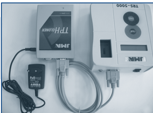
Rys. 2 Przedstawienie kroków 1 i 2 połączenia TPH Cloner – TRS-5000.
