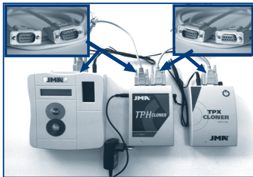
Fig.5. Representación final del cableado listo para proceder con la clonación, bien del Philips Crypto o del Texas Crypto..
