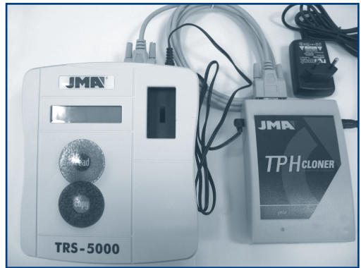
Abb. 2. Zeigt die Schritte 1 und 2 zum Anschluss des TPH Cloner TRS5000.
