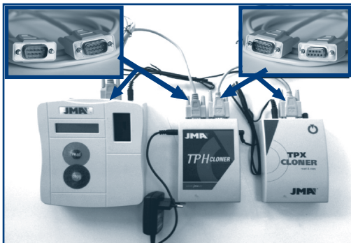
Fig.5. Représentation finale du câblage prêt au clonage, soit de la Philips Crypto, soit de la Texas Crypto.
