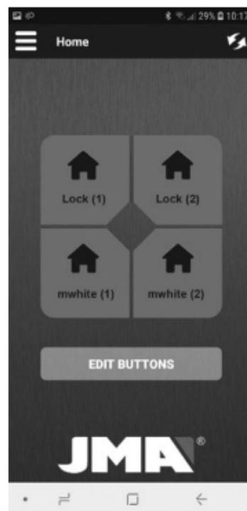
W ramach każdego z 4 przycisków na ekranie istnieje możliwość konfiguracji dowolnego przycisku otwierania z dowolnego pilota przypisanego do systemu. Po naciśnięciu przycisku, który ma zostać edytowany, otwiera się ekran przedstawiający wszystkie piloty przypisane do danego konta.
